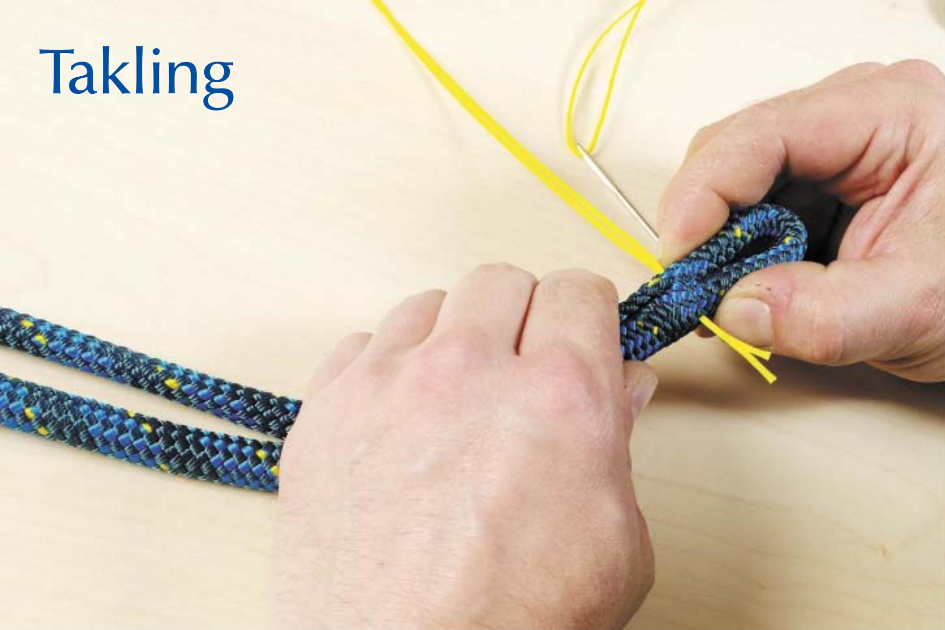
LIROS-Takelgarn doppelt in spezielle Takelnadel einfädeln und durch den Schlaufenanfang stecken.
