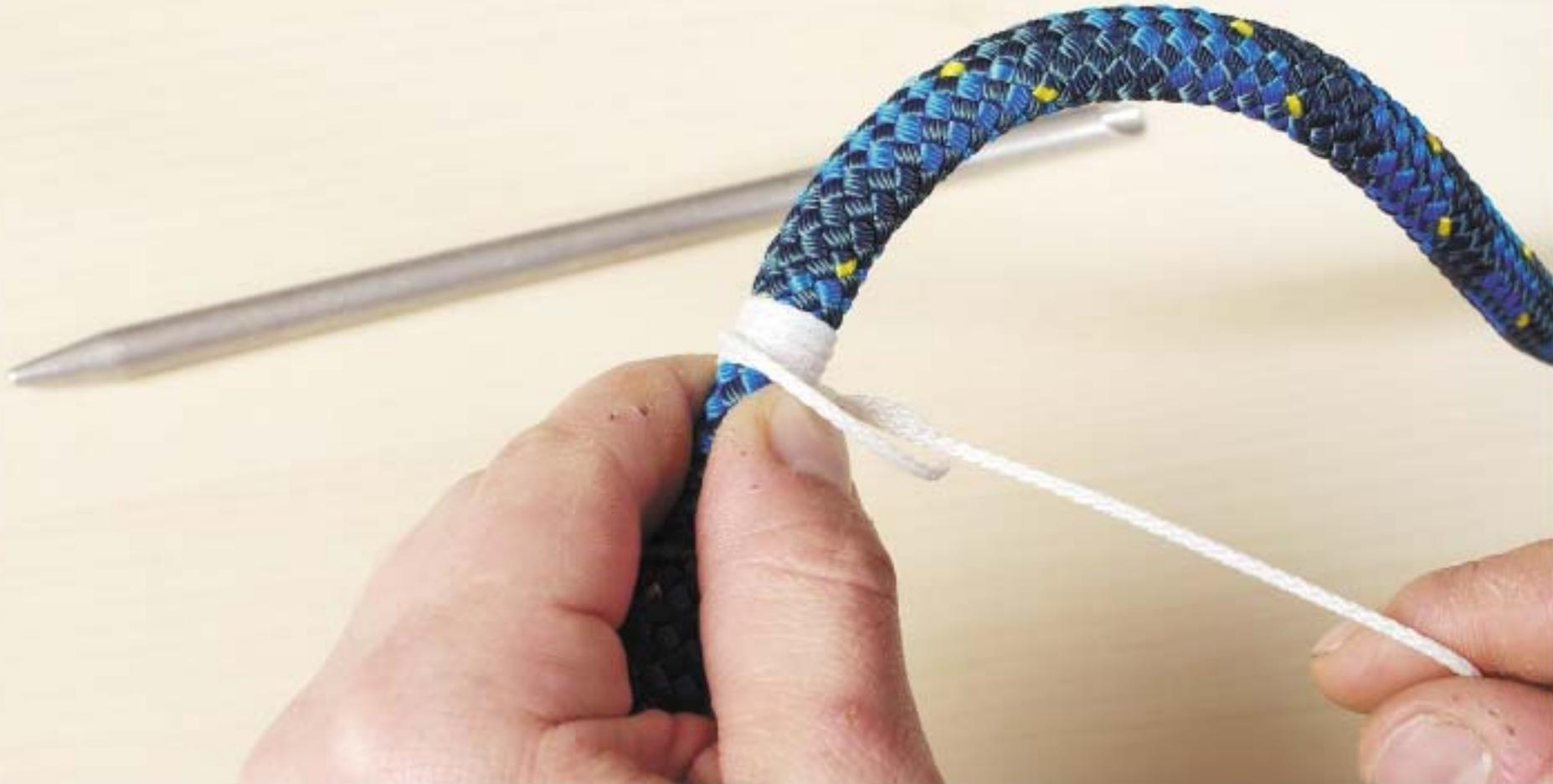
Nach einer Länge von  $40 \times$  Seildurchmesser ein erstes Takling setzen.
