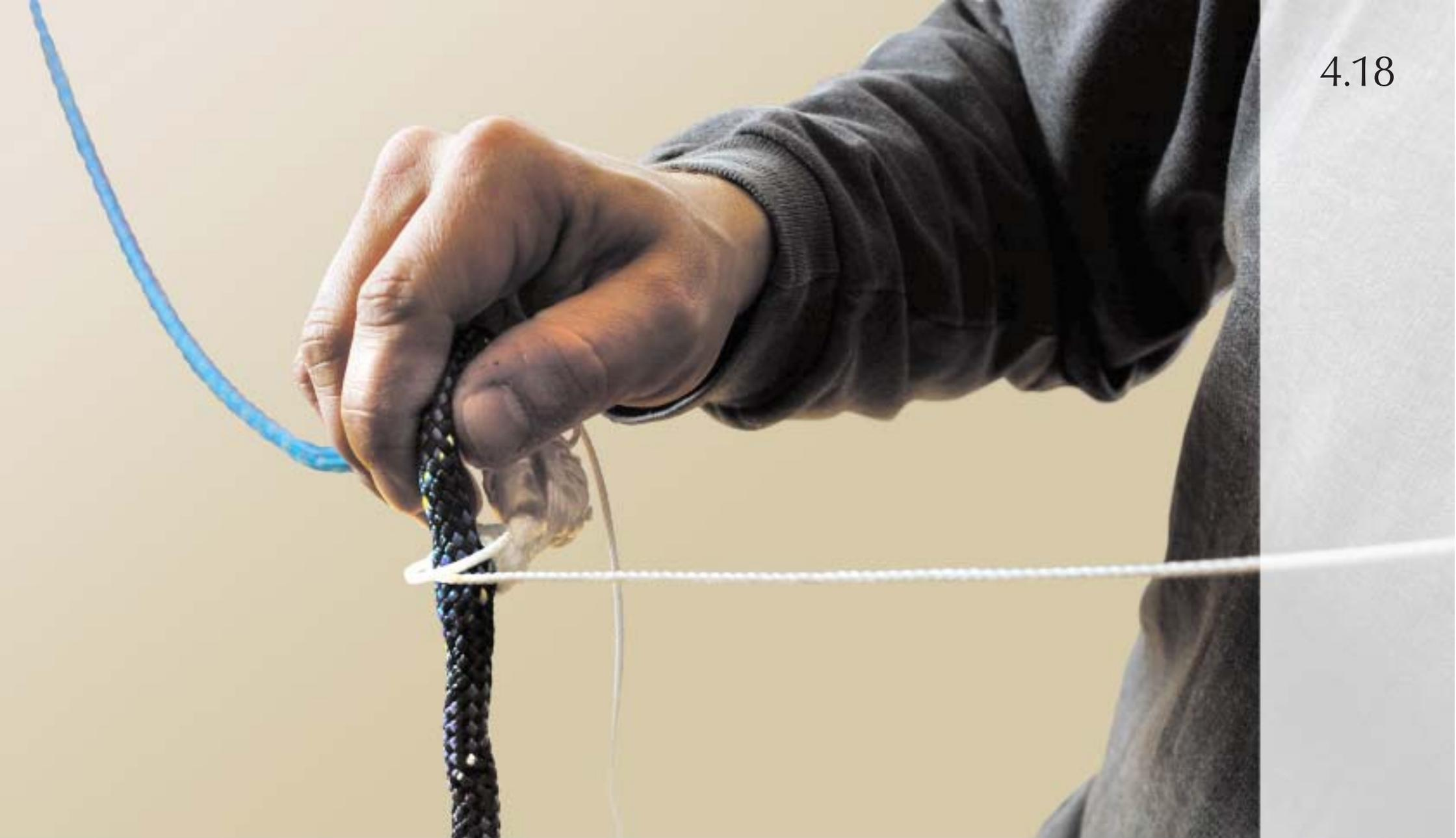
Kurz vor Fertigstellung des Auges, beide Taklings entfernen.
