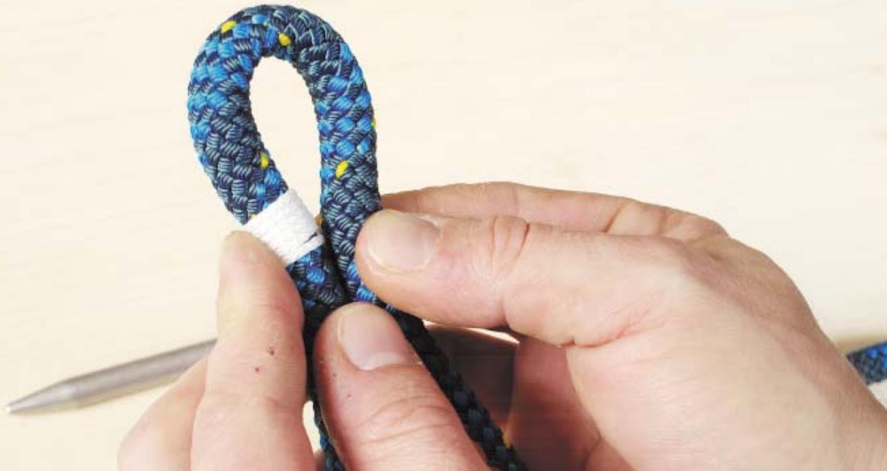
Ein zweites Takling nach dem Auge in Richtung Seilmitte setzen.
