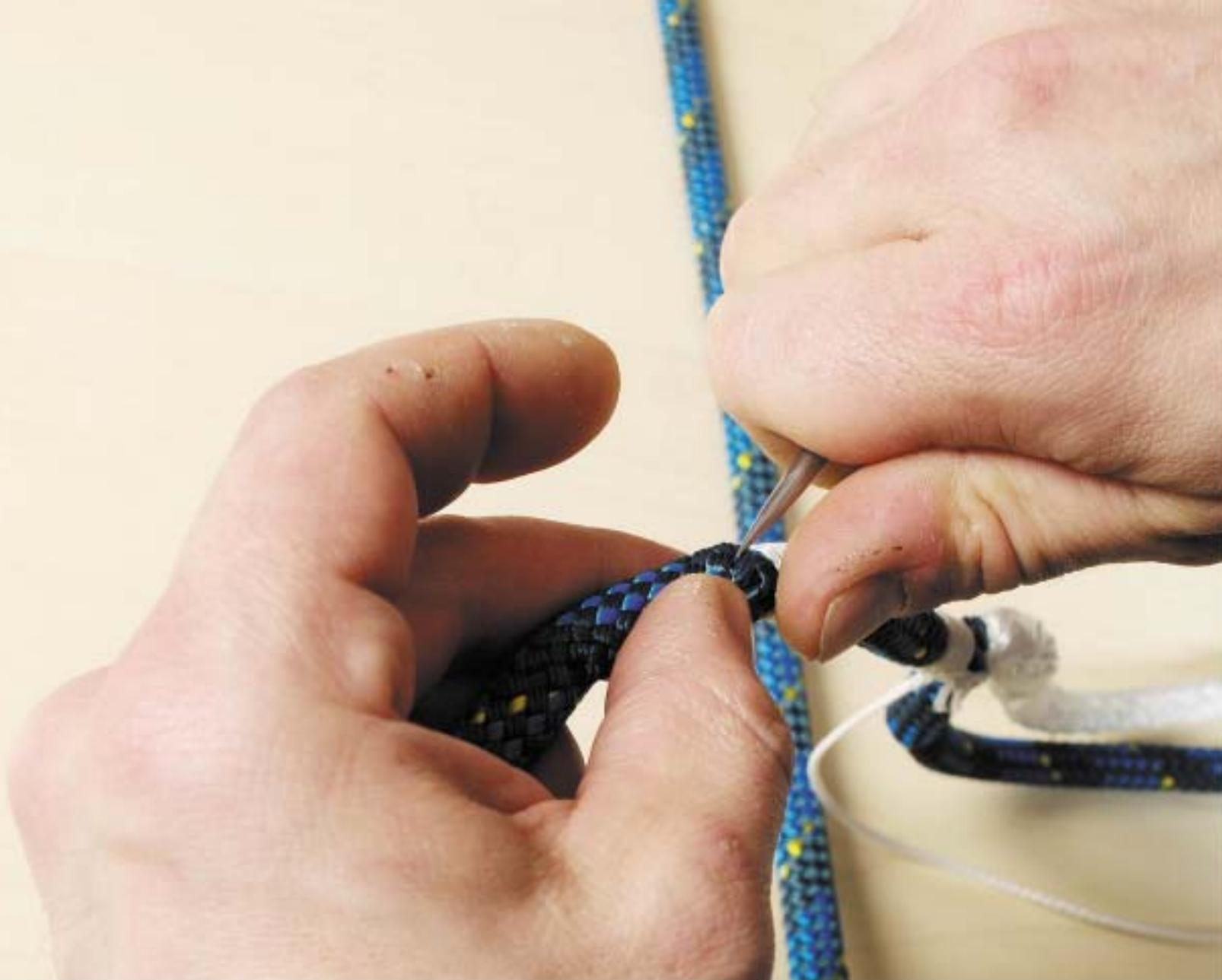
Nach dem 2. Takling genauso Mantel öffnen und Kern herausziehen. Vorsicht! Nicht den Kern aus dem Takling ziehen. Größtmögliche Schlaufe herausziehen.
